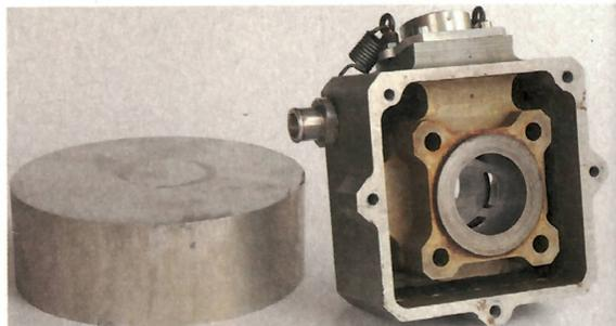
Buchstäblich aus dem Vollen gearbeitet: Am Beginn der „Zylinderentwicklung“ stand ein Aluklotz
