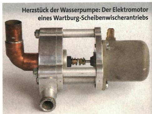
Herzstück der Wasserpumpe: Der Elektromotor eines Wartburg-Scheibenwischerantriebs
